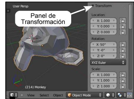
**Figura 14** Uso del panel de Transformación para establecer un valor preciso.
