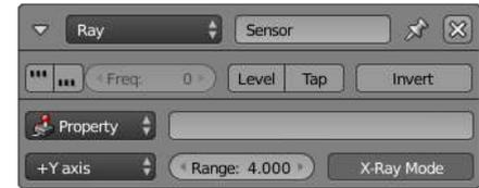
Este sensor lanza un rayo en una dirección, indicada en el eje **Axis**. Este eje está definido en coordenadas locales. El campo **Range** sirve para definir la longitud del rayo. Igual que en el sensor *Collision*, es posible filtrar los objetos que intersecurán con el rayo por **Material** o Propiedad (**Property**).
