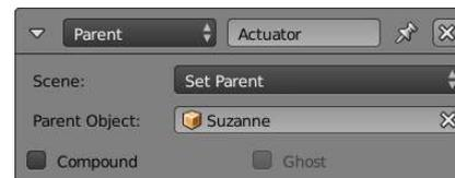
Mediante este actuador se establece (con la opción **Set Parent**) o se elimina (con **Remove Parent**) la relación de parentesco entre objetos. Recordemos que mediante el parentesco, los objetos siguen siendo elementos independientes pero las transformaciones aplicadas al padre (traslación, rotación, escala...) son heredadas por el objeto hijo, pero no al contrario.
