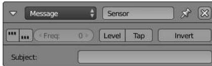
Permite recibir mensajes de otros objetos. El campo **Subject** se puede dejar en blanco, de modo que recibe cualquier mensaje. Si se especifica una cadena de texto, solo se recibirán mensajes que tengan ese asunto concreto. El contenido del mensaje (**Body**) solo puede ser accedido mediante un controlador que ejecute código Python.
