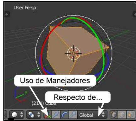
**Figura 13** Uso de manejadores. En este caso se utiliza el manejador de rotación.
