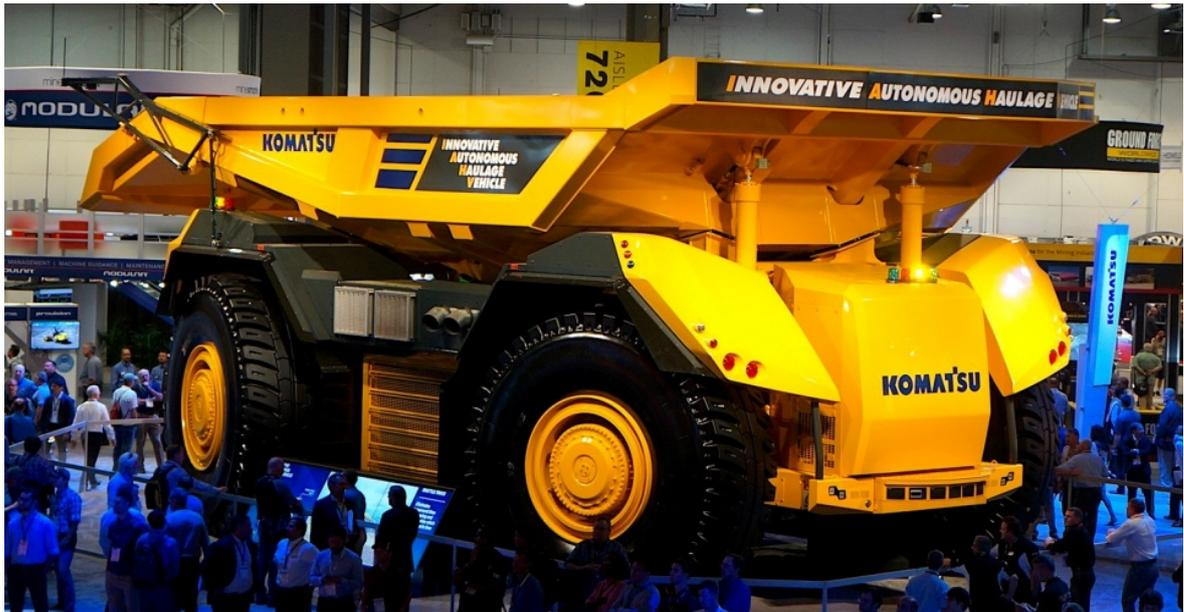
Figura 5.7: Volquete sin cabina de Komatsu, denominado Autonomous Haulage Vehicle (AHV).
