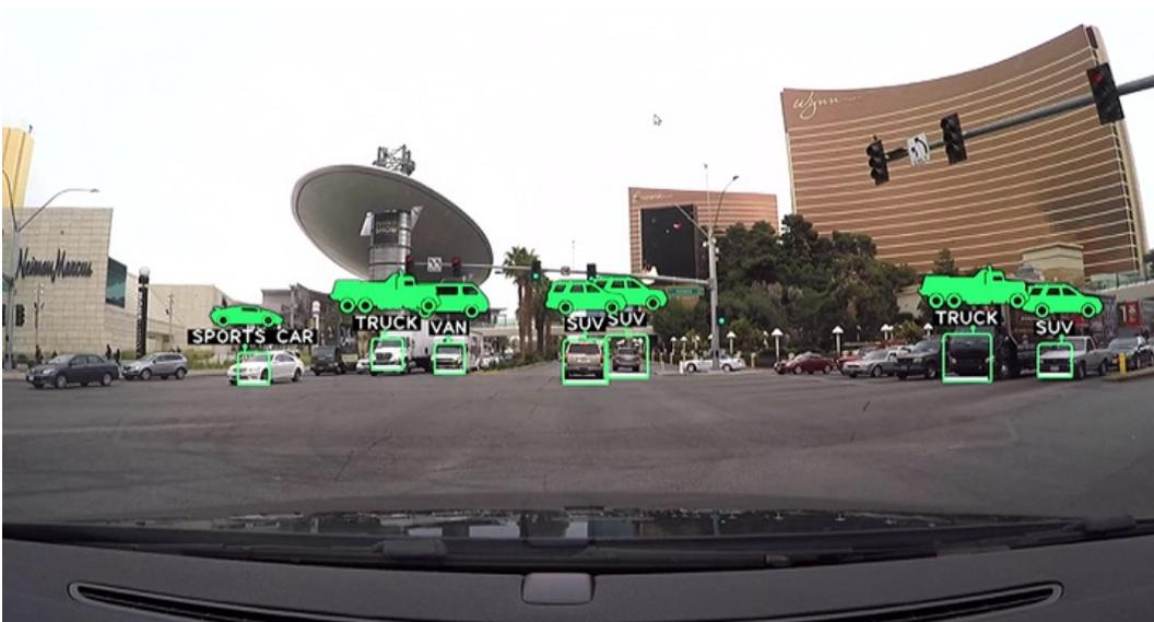
Figura 5.24: Detección de obstáculos del SDK *NVIDIA DriveWorks*.
