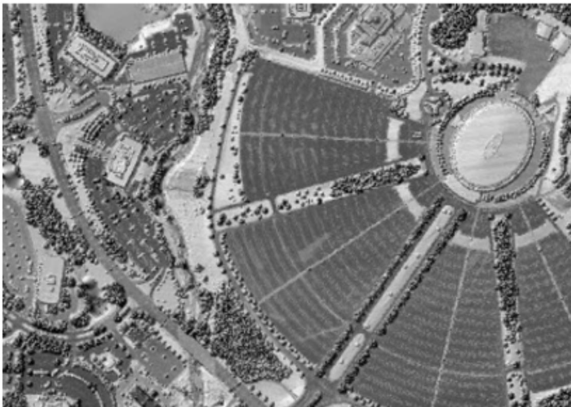
Figura 4.14: Imágenes generadas a partir de la intensidad del pulso laser. <http://desktop.arcgis.com/es/arcmap/10.3/manage-data/las-dataset/what-is-lidar-data-.htm>
