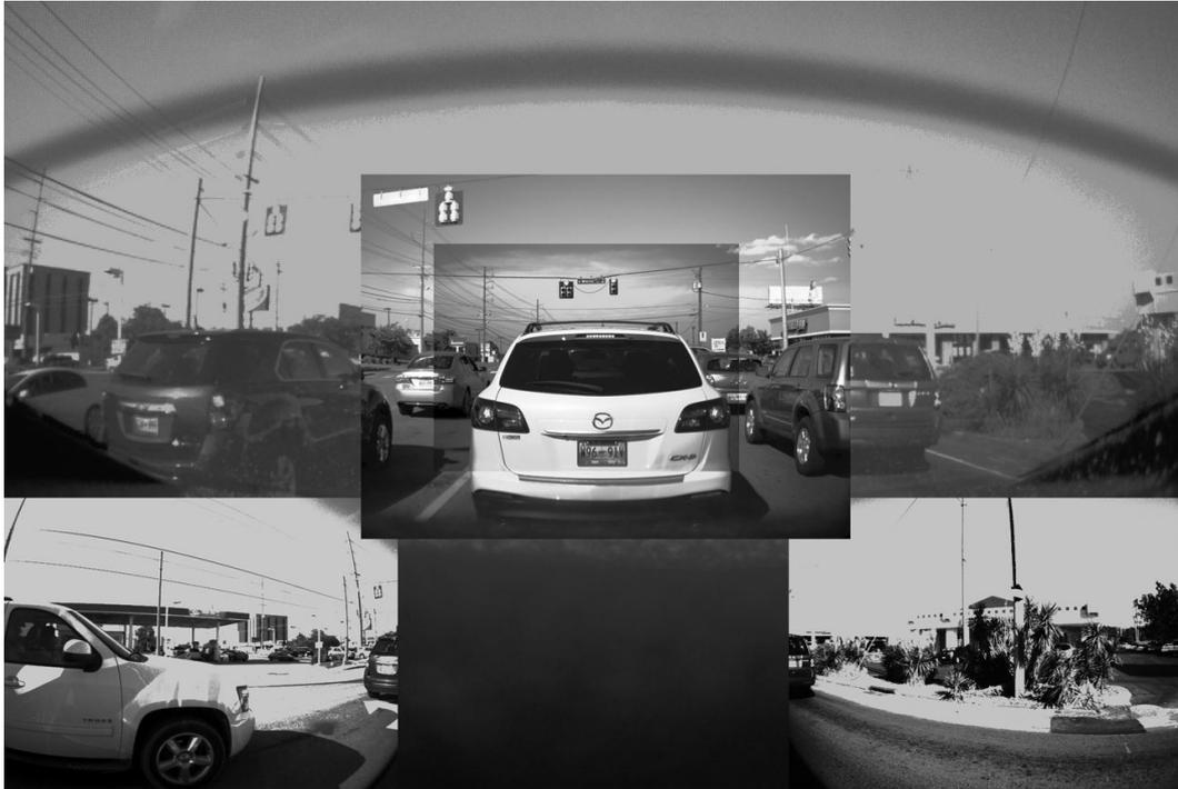
Figura 5.20: Visión conjunta del autopilot del vehículo *Tesla*. <https://www.motorpasion.com/tecnologia/lidar-si-o-lidar-no-esa-es-la-cuestion-con-los-coches-autonomos>
