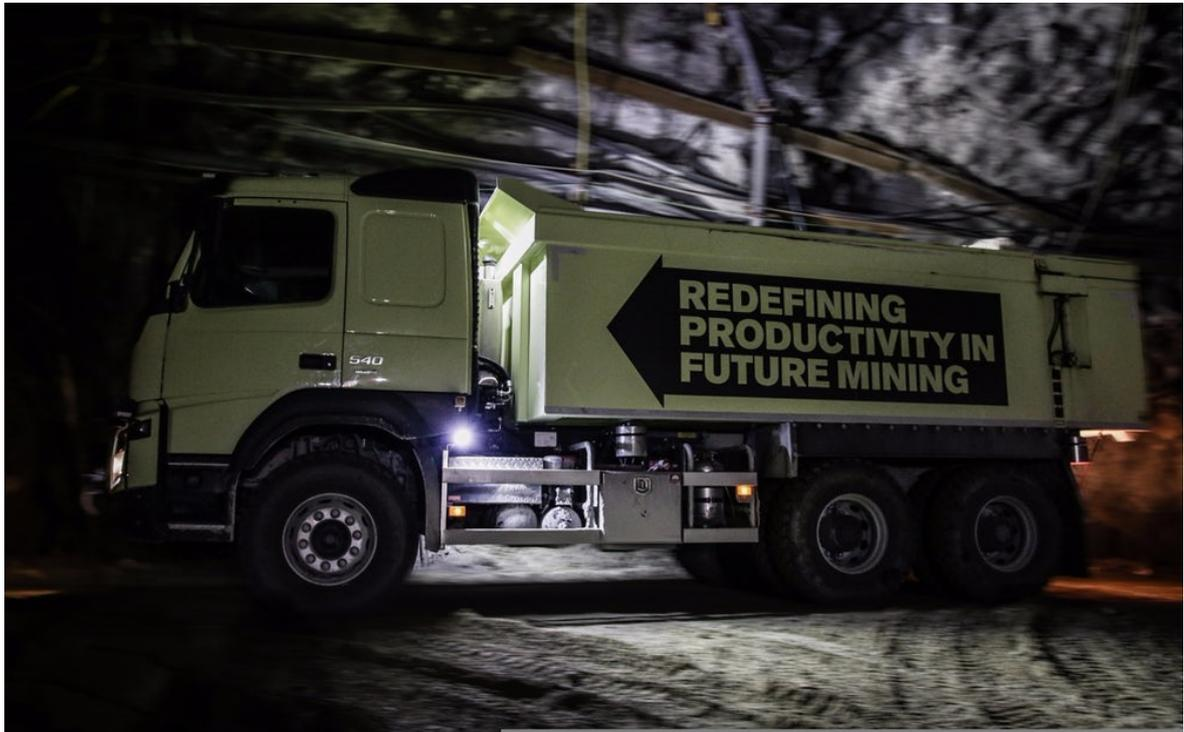
Figura 5.12: Volvo FMX totalmente autónomo realizando un recorrido de prueba en las profundidades de la mina Kristineberg.
