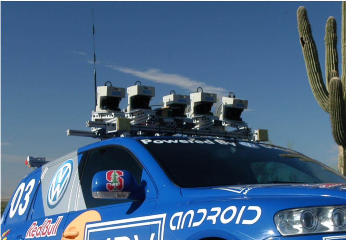
Figura 5.15: Sensores LIDAR de la empresa Sick AG montados sobre el vehículo Stanley.
