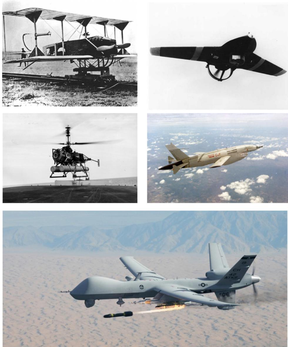
Figura 3.4: Diversos tipos de UAVs a lo largo de los años. De izquierda a derecha y de arriba abajo: avión automático Hewitt-Sperry, Aquila RPV-drone, DASH , Ryan AQM-34L Firebee drone *Tom Cat*, MQ 9 Reaper Drone. <http://eldrone.es/historia-de-los-drones/>
