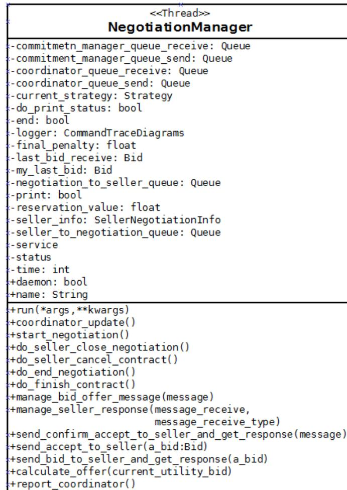
Figura 4.15: Diseño UML del hilo Negotiation Manager
