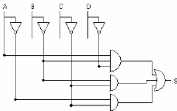
Estructura de dos niveles con puertas de dos entradas (OR-AND):
