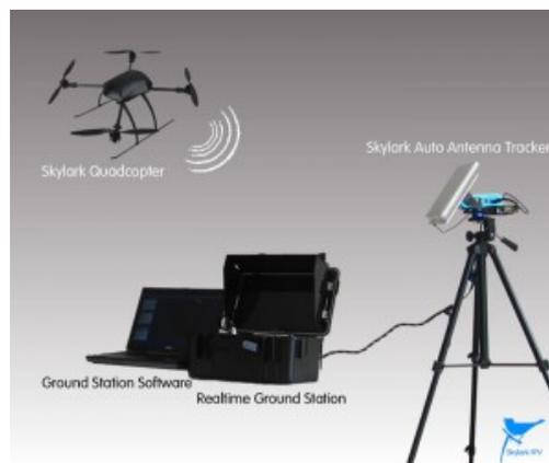
**Ilustración 54. Antena tracker con estación de tierra**
