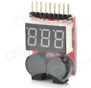
Ilustración 68. Avisador acústico de batería baja
