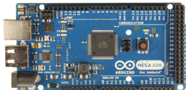
Ilustración 37. Arduino ADK
