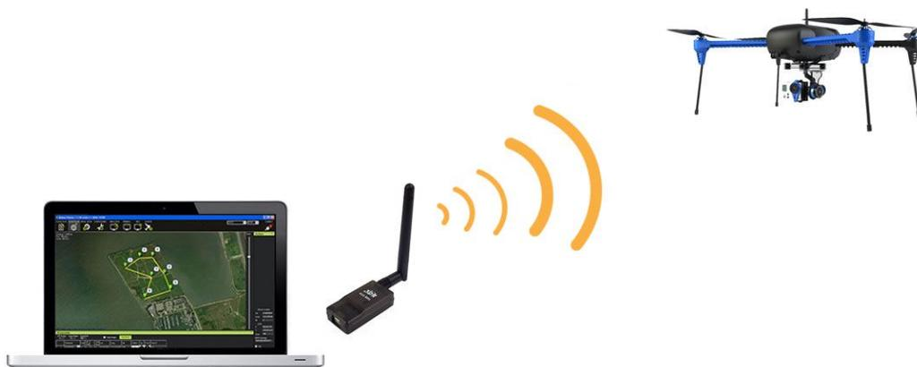
Ilustración 48. Comunicación entre un UAV y su estación base
