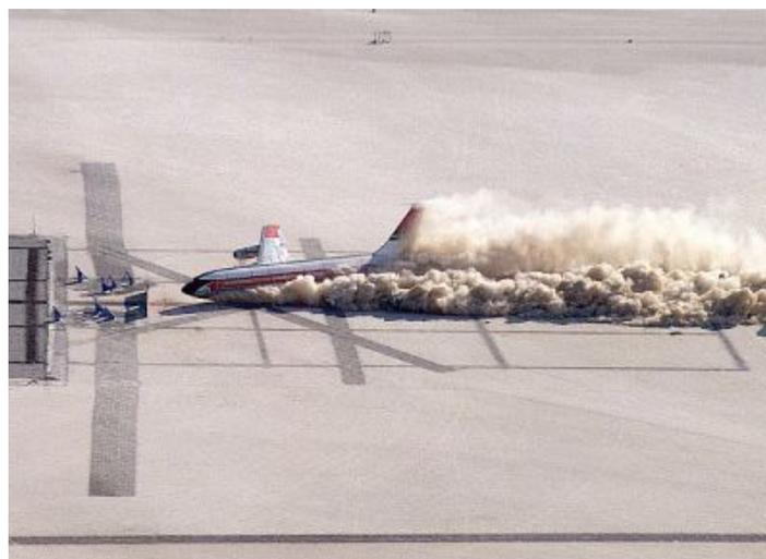
Ilustración 11. Drone de investigación Boeing 720 simulando un accidente aéreo
