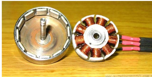
**Ilustración 26. Interior de un motor *Brushless***
