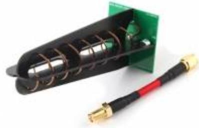
**Ilustración 53. Antena de polarización circular direccional**
