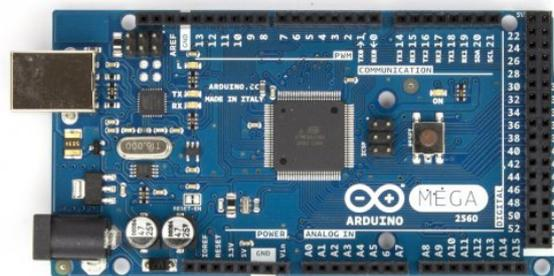
Ilustración 38. Arduino MEGA2560
