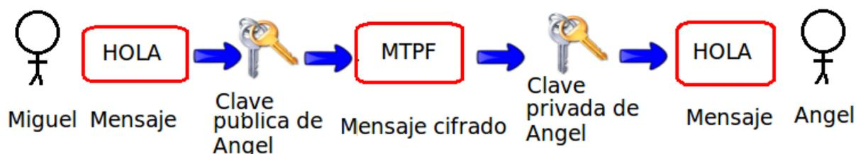
**Figura 3.11:** Ejemplo de codificación de la información mediante el uso de una clave asimétrica
