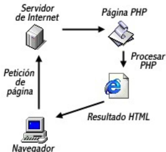
Figura 3.3: Esquema del proceso de una petición web
