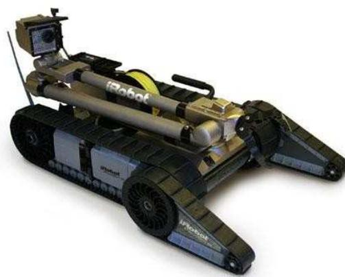
*Ilustración 17: Robot rodante con orugas*
