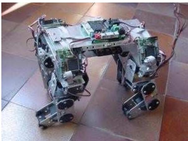
*Ilustración 22: Estructura básica fabricada en aluminio para un robot cuadrúpedo.*
