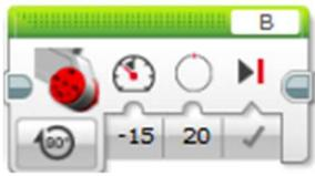
En el arranque el programa antes de comenzar a avanzar, el servomotor B incrementa los grados iniciales en 20° hacia arriba, para favorecer las lecturas del sensor de ultrasonido.
