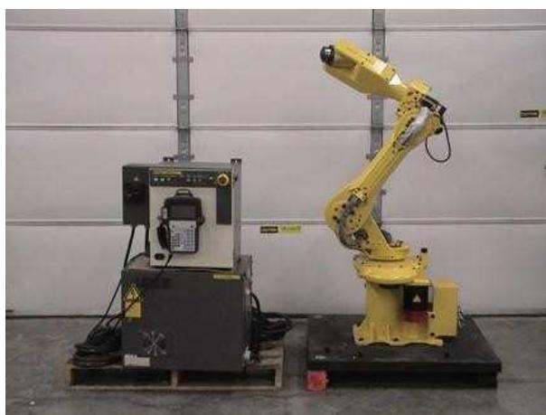
*Ilustración 11: Robot industrial de 3ª generación FANUC*
