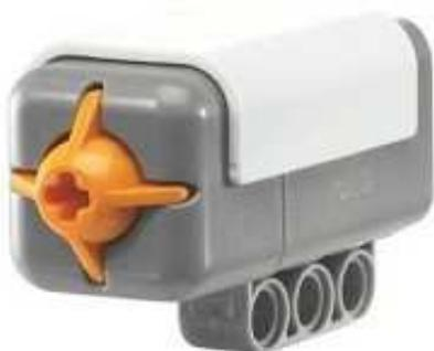
*Ilustración 65: Sensor de tacto de LEGO Mindstorms*
