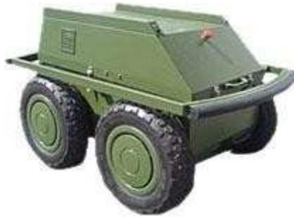
*Ilustración 14: Robot rodante de 4 ruedas, 2+2*
