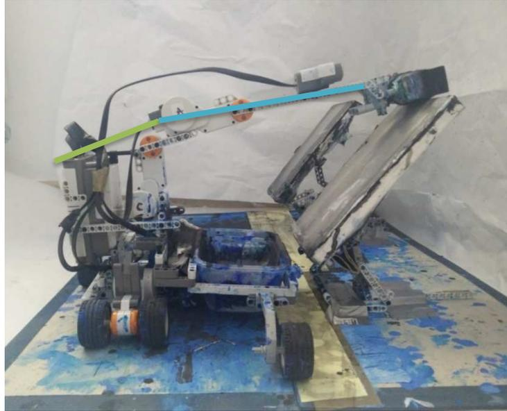
*Ilustración 80: Vista lateral de prototipo final ejecutando ensayo de limpieza usando tinta para señalar las zonas donde hay contacto en los barridos.*
