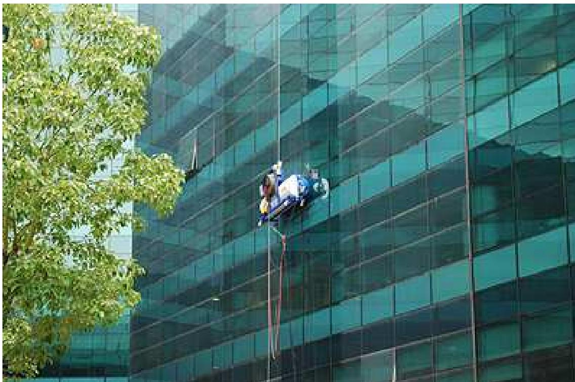
*Ilustración 37: Robot de limpieza HighRise de IPC subiendo y limpiando pared de cristal.*
