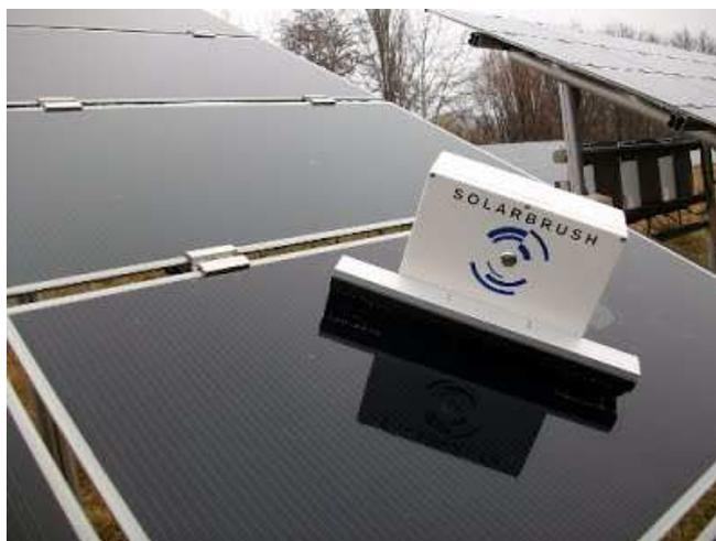
*Ilustración 38: Robot limpiador de la compañía Solarbrush.*
