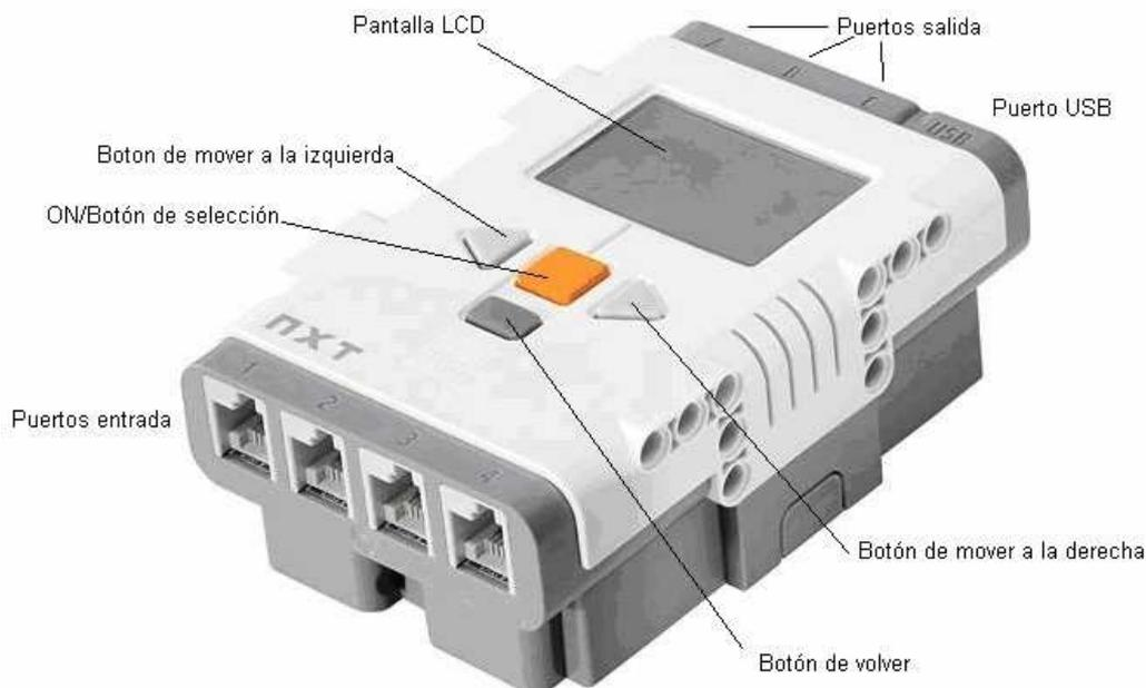
*Ilustración 64: Partes del bloque NXT*
