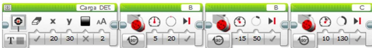
Ilustración 102: Parte B: movimiento de bajada para humedecer con líquido la esponja de la pala de limpieza.
