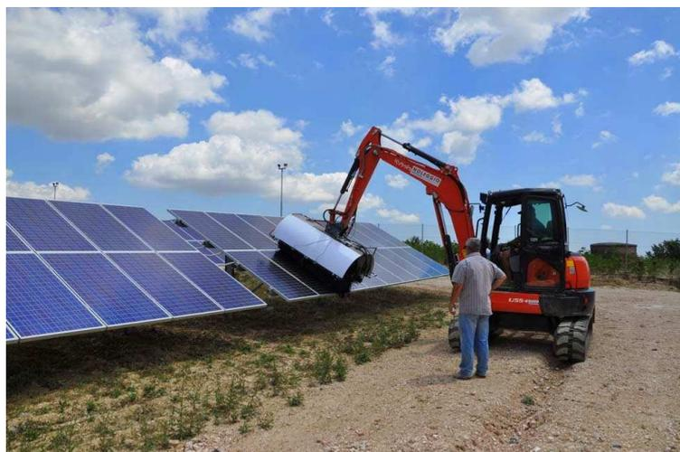
*Ilustración 34: Método de limpieza por rodillo*
