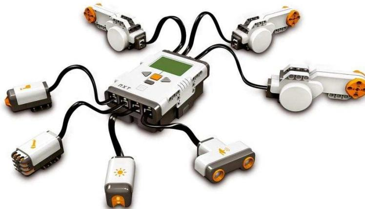
Ilustración 57; Ladrillo LEGO con todos sus sensores y servomotores conectados a la vez.
