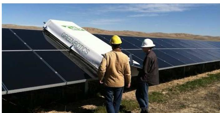
*Ilustración 39: Modelo de Greenbotics como solución de la limpieza automatizada.*
