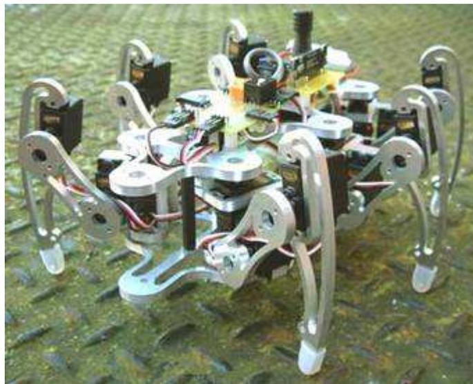
*Ilustración 19: Robot zoomórfico multipedo*
