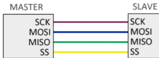
**Figura 3.8:** Esquema de conexión módulo micro SD.
