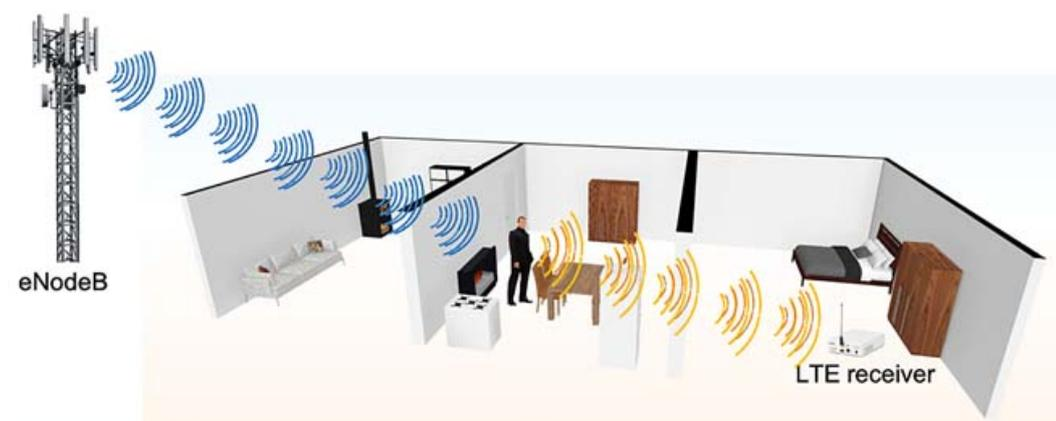
**Figura 3.4:** Representación de la estimación de densidad de ocupación en base al uso de señales inalámbricas LTE [14].
