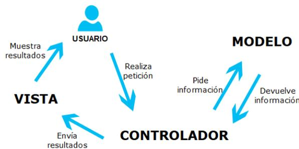
Figura 3.13: Esquema general del patrón de arquitectura de *software* MVC.
