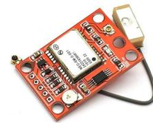
Figura 3.8: Imagen del sensor NEO-6M <sup>9</sup>
