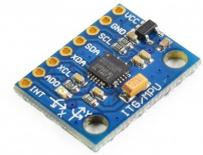
Figura 3.5: Imagen del sensor MPU6050 <sup>7</sup>
