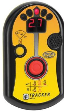
Figura 1.5: Dispositivo ARVA para la búsqueda de montañistas en avalanchas. <sup>5</sup>
