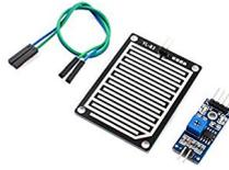
Figura 3.7: Imagen del sensor de lluvia YL-83 <sup>8</sup>
