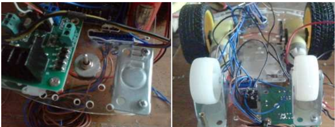
Ilustración 103: Sustitución de rueda móvil por ruedas fijas.
