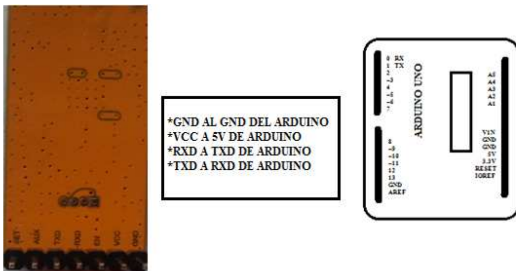
Ilustración 100: Esquema conexión módulo APC220 al Arduino.
