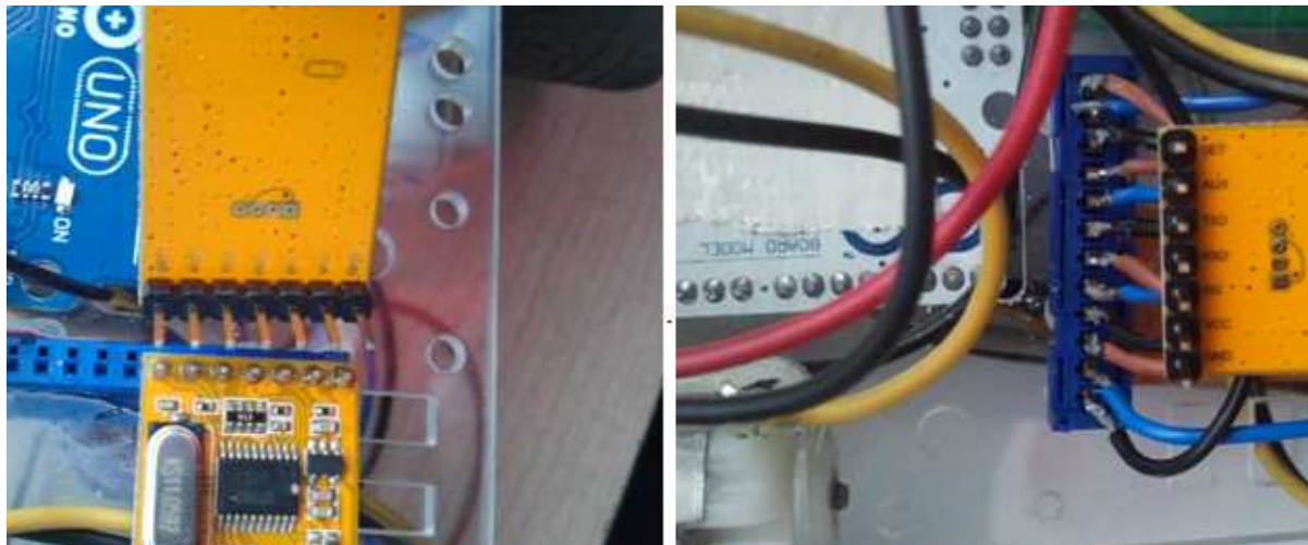
Ilustración 99: Identificación de los pines del módulo APC220.
