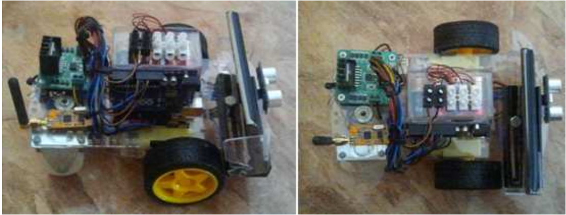
Ilustración 118: Robot controlado por voz con lógica difusa.
