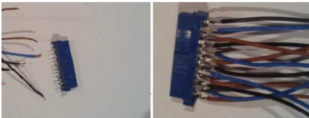
Ilustración 91: Soldado de cables a los conectores.
