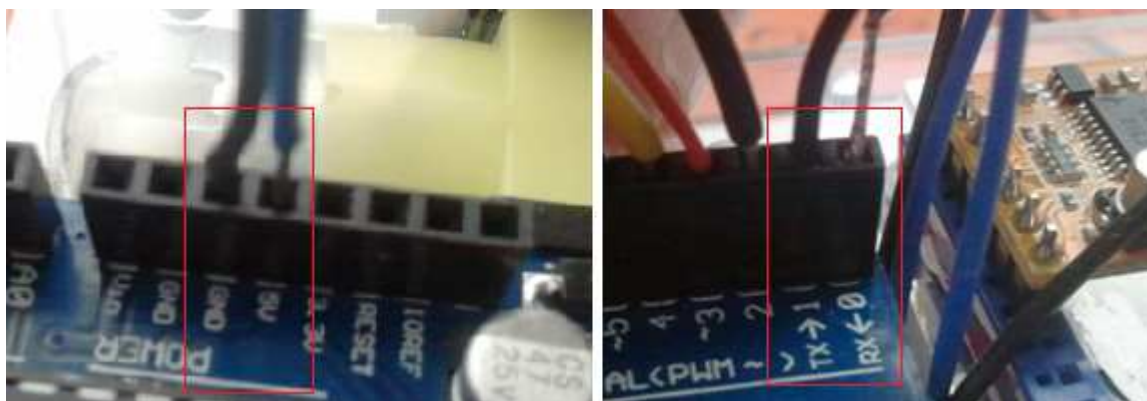
Ilustración 101: Conexión de los cables del conector del módulo APC220 al Arduino.
