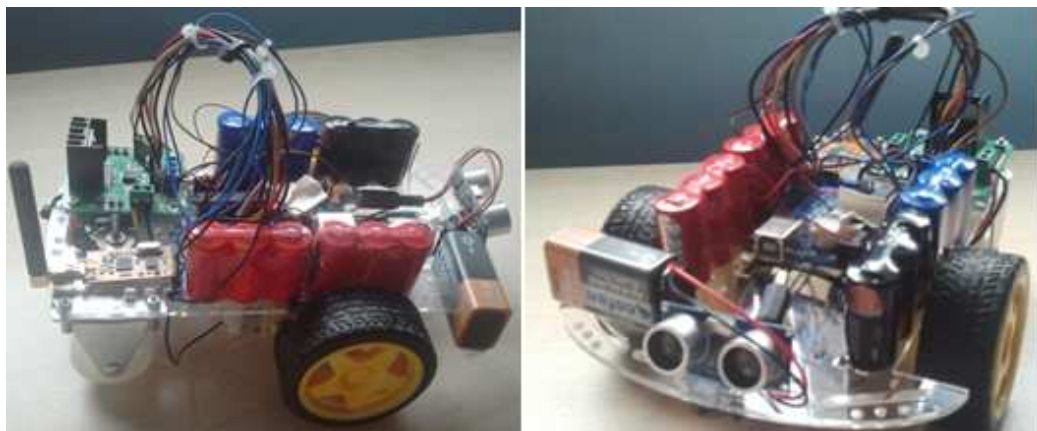
Ilustración 105: Robot con ruedas fijas y baterías de prueba.
