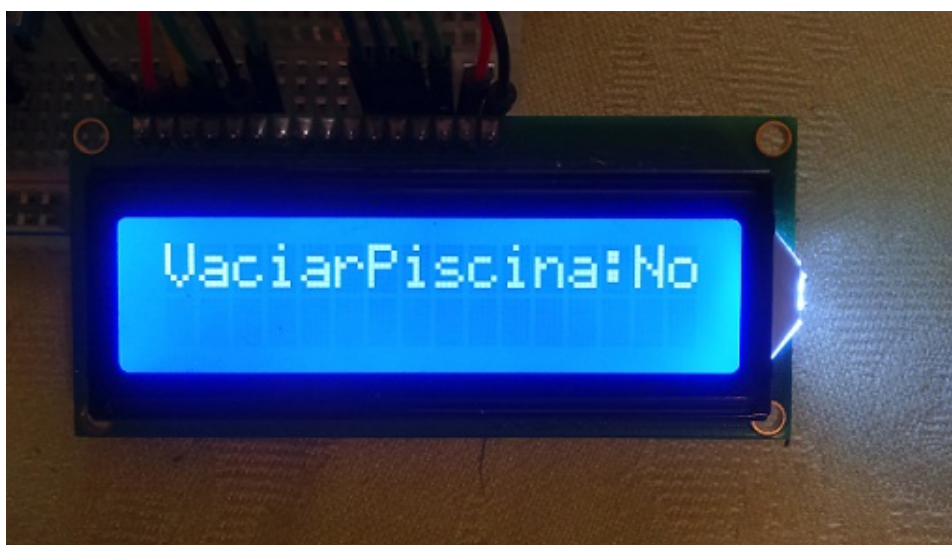
Ilustración 96: Pantalla LCD en el control de nivel de agua de la piscina climatizada.
