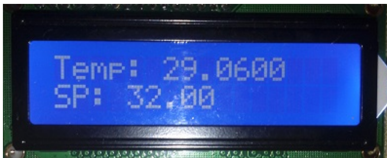
Ilustración 130: Pantalla LCD del control de temperatura del agua de la piscina climatizada.
