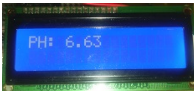
Ilustración 142: Pantalla LCD medida PH leche.
