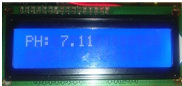
Ilustración 140: Pantalla LCD medida PH agua.
