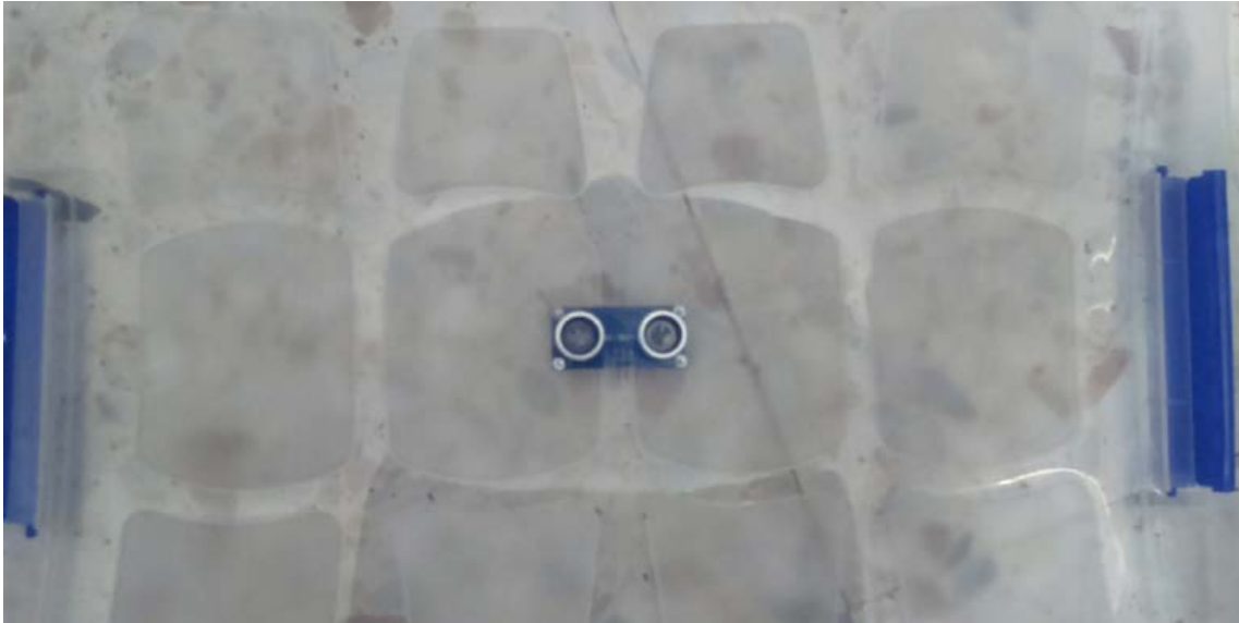
Ilustración 94: Instalación sensor de ultrasonidos.
