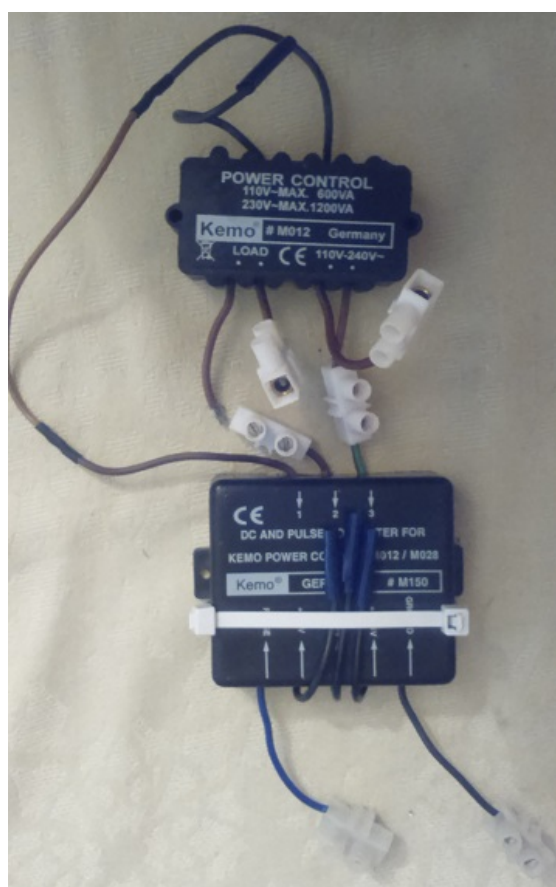
Ilustración 127: Montaje del regulador de potencia Kemo.
