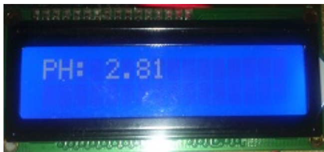
Ilustración 144: Pantalla LCD medida PH Coca-Cola.
