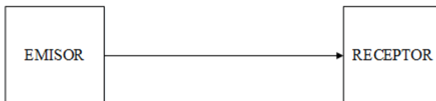
Ilustración 42: Detección por barrera.
