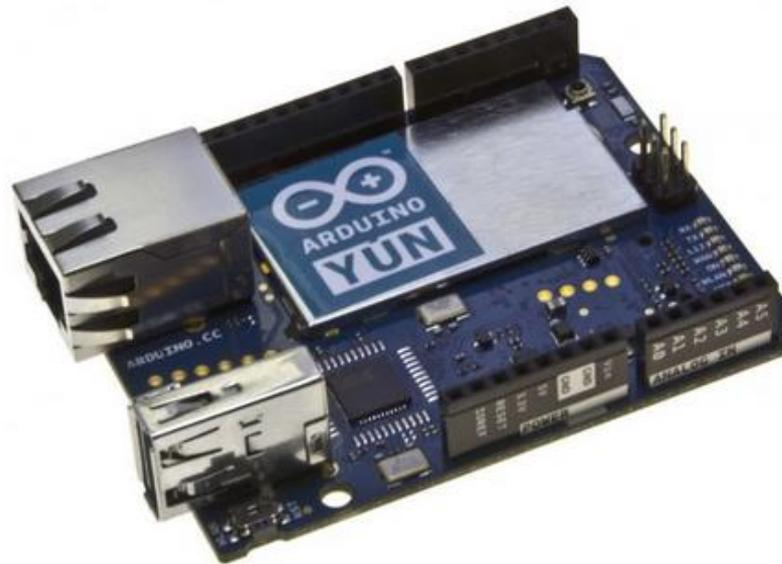
Ilustración 18: Placa Arduino YÚN
