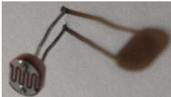
Ilustración 44: Aspecto del sensor LDR CE-C2795
