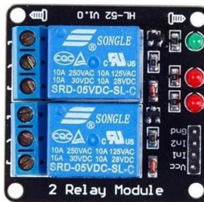
Ilustración 71: Aspecto de placa de 2 relés 5V para Arduino
