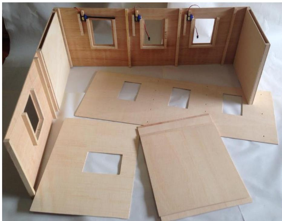
**Ilustración 50: Montaje de las paredes del entorno de pruebas**
