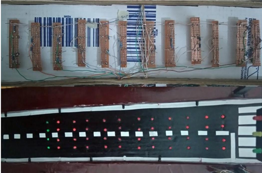
Ilustración 84: aspecto físico de Circuito completo de todas las barreras luminosas
