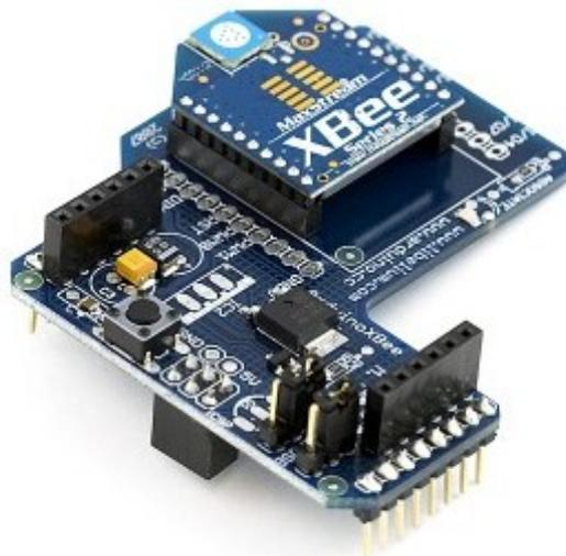
Ilustración 48: Shield de Arduino con Módulo XBee
