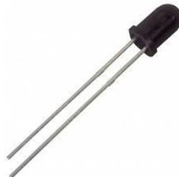
Ilustración 54: Diodo receptor de infrarrojos
