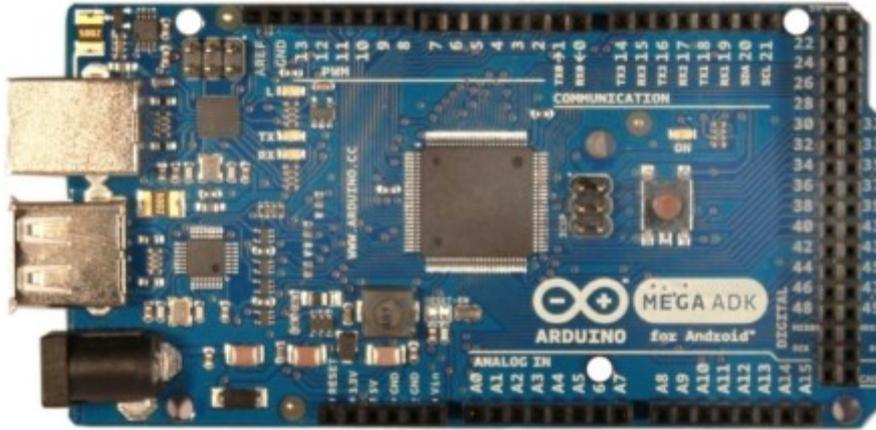
Ilustración 33: Arduino ADK
