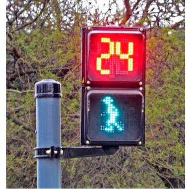
**Ilustración 11: semáforo con contador**
