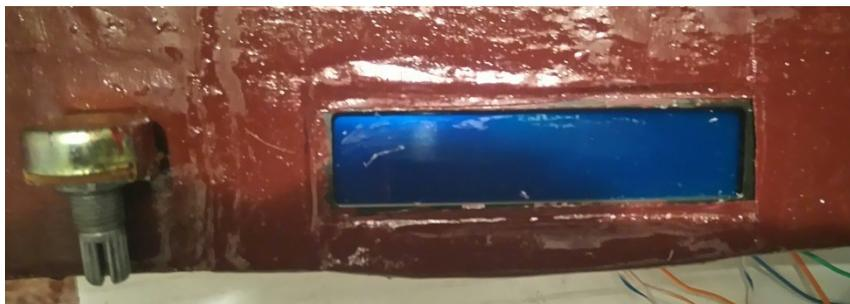
Ilustración 93: pantalla LCD con un potenciómetro regulador
