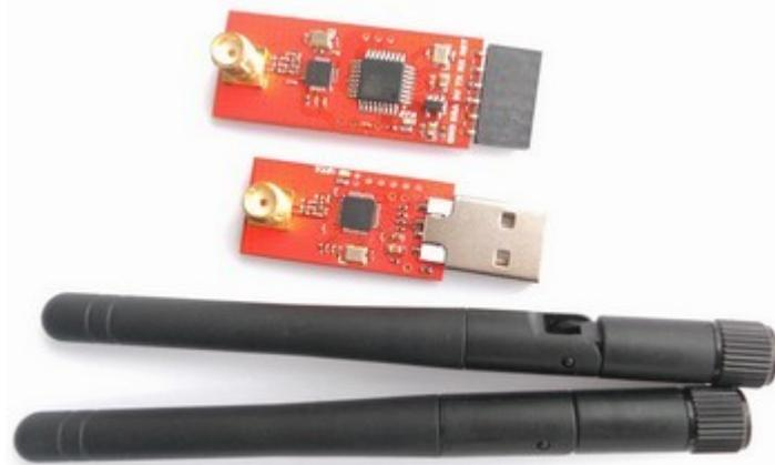
Ilustración 49: Módulos nRF24LU1 y nRF201
