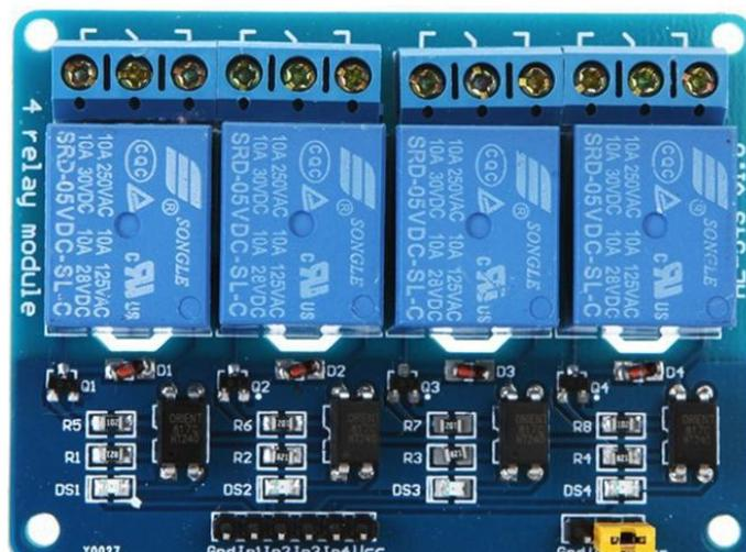
Ilustración 101: Módulo relé de 4 canales
