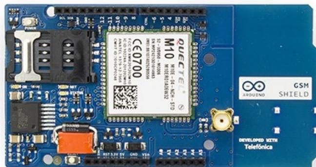
Ilustración 41: Placa shield Arduino GSM
