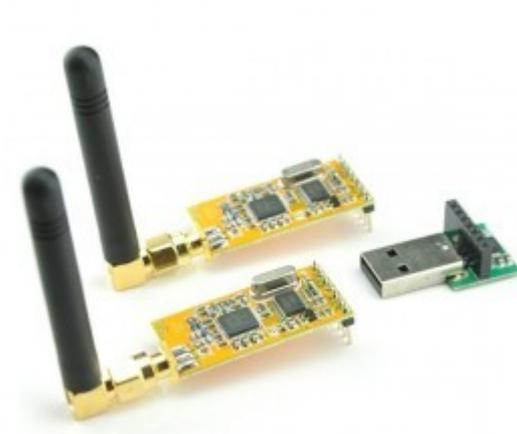
Ilustración 47: Conector USB del Módulo APC220 y antena emisor-receptor
