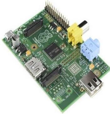
Ilustración 11: Microprocesador Raspberry Pi A
