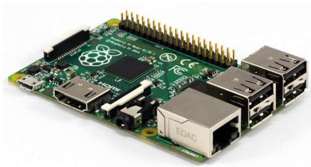
Ilustración 15: Microprocesador Raspberry Pi B+
