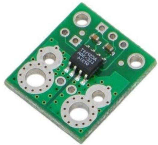
Ilustración 35: Sensor corriente ACS714
