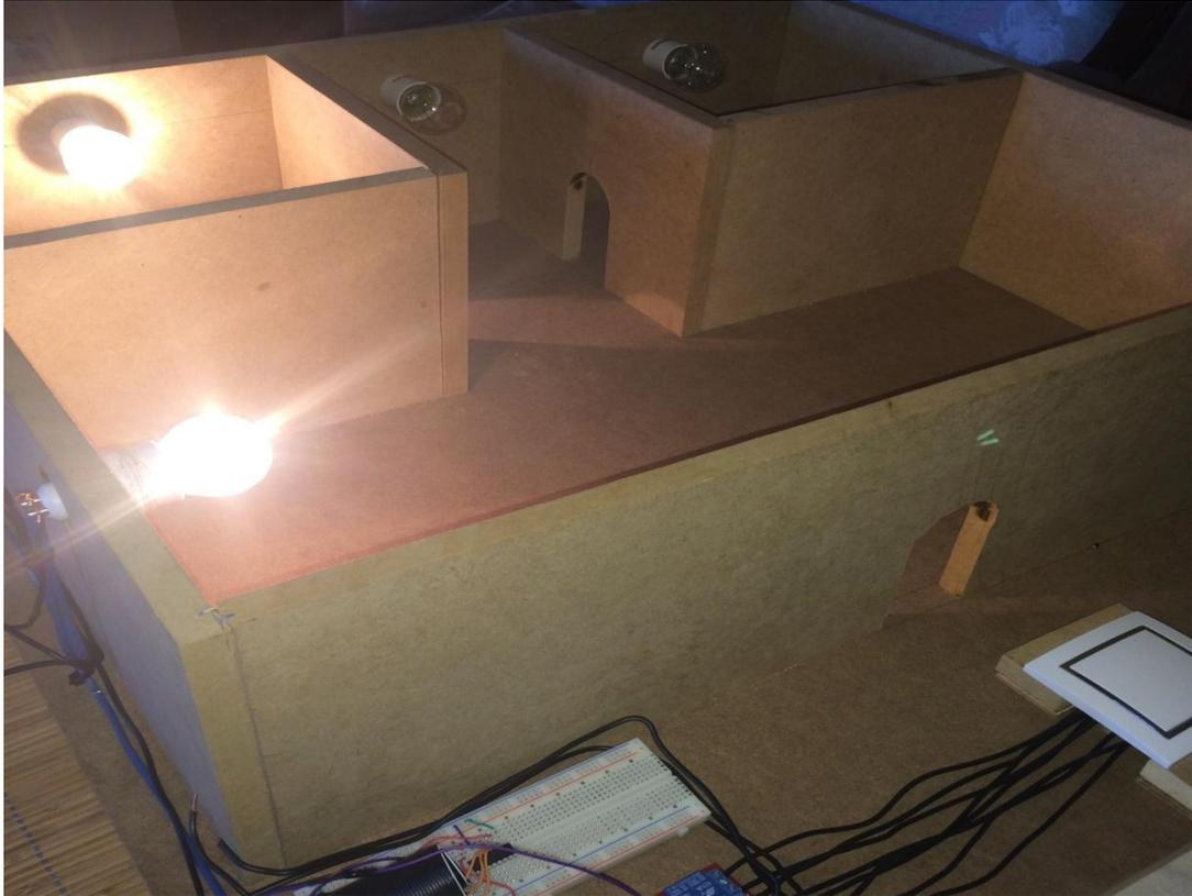
Ilustración 66: Maqueta iluminada por accionamiento web.
