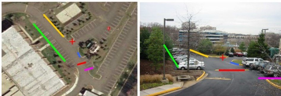
Figura 2.18: Métodos de calibración de cámaras propuesto en [217]. En la imágenes se puede apreciar como se marcan las zonas en común observadas desde cámaras diferentes.
