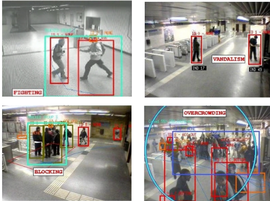
Figura 2.12: Situaciones en estaciones subterráneas de metro detectadas en [56].
