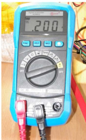
Ilustración 113. Consumo en mA. de la electrónica.
