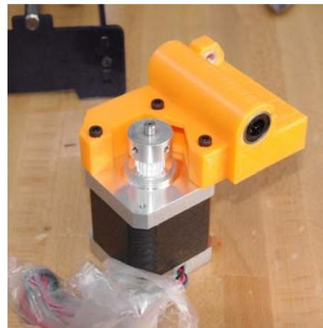
Ilustración 64. Ensamblado X-Axis motor end.
