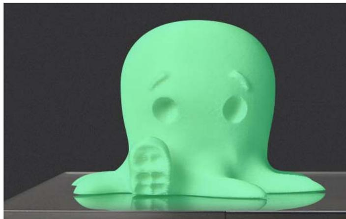
Ilustración 42. Pieza realizada con filamento fluorescente *Glow in the Dark*. Fuente: [www.thor3d.ca](http://www.thor3d.ca)
