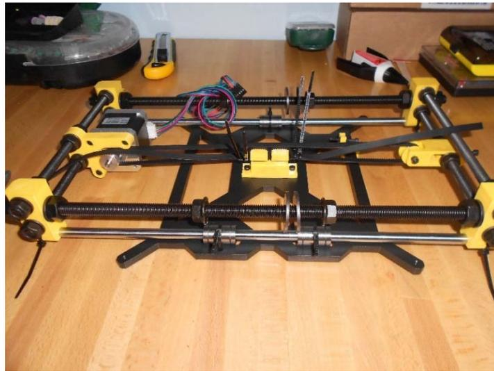
**Ilustración 206. Montaje correa eje Y.**
