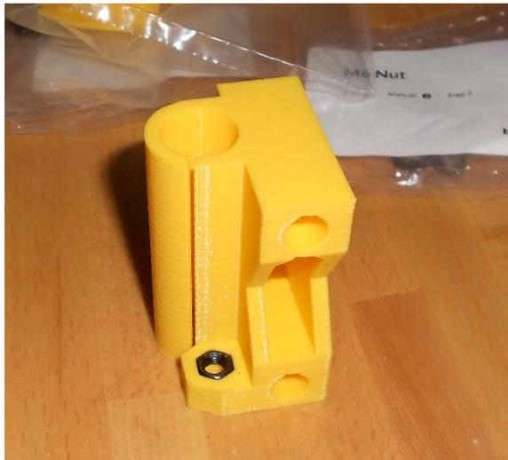
**Ilustración 194.** Montaje de tuercas en elemento de eje X.
