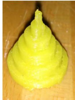
Ilustración 170. *Dimensional accuracy test extrusor 1*. Ilustración 171. *Dimensional accuracy test extrusor 2*.
