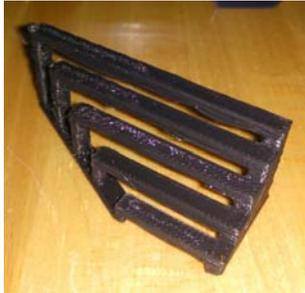
Ilustración 176. *Bridging test* extrusor 1.
