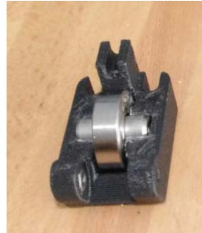
Ilustración 78. Montaje extruder idler.
