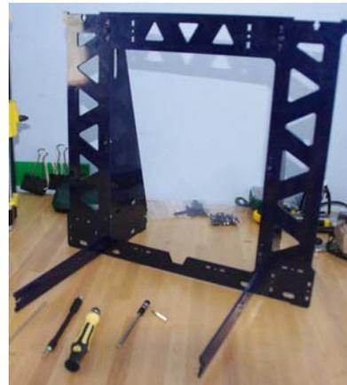
Ilustración 48. Montaje marco de acero.
