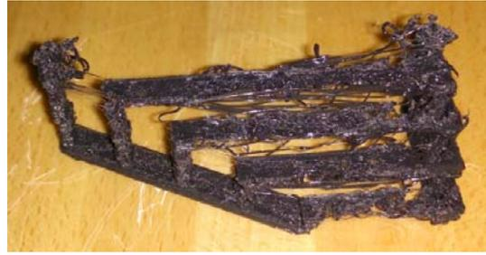
Ilustración 153. *Bridging test*.
