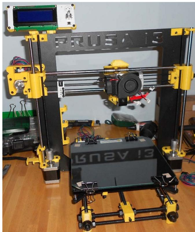
Ilustración 215. Impresora montada a falta de cableado.
