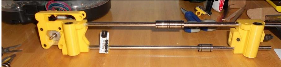
Ilustración 201. Ensamblaje eje X.
