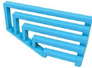
Ilustración 175. *Bridging test*. Fuente: Revista Make vol.42
