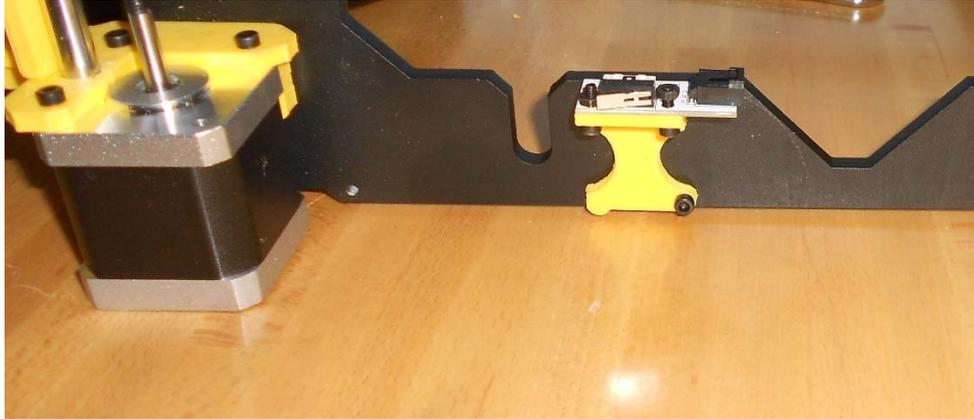
Ilustración 208. Instalación *endstop* de eje Y.
