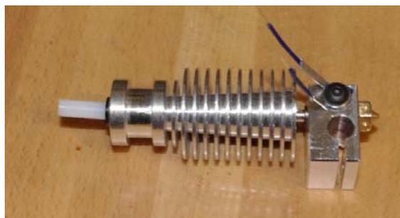
**Ilustración 94. Montaje disipador de calor.**
