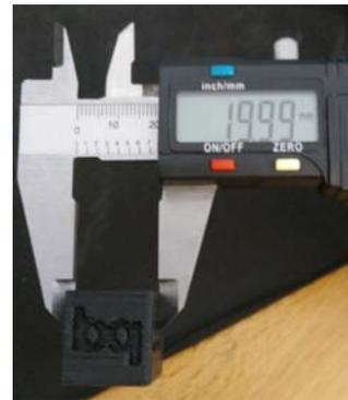
Ilustración 164. Medición eje Y cubo de calibración primer extrusor.
