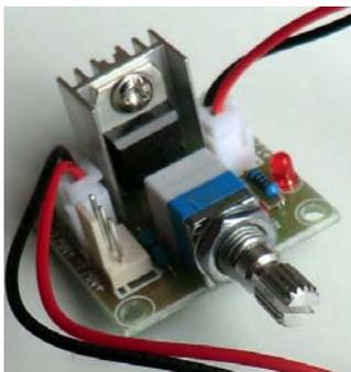
Ilustración 142. Circuito integrado LM317.
