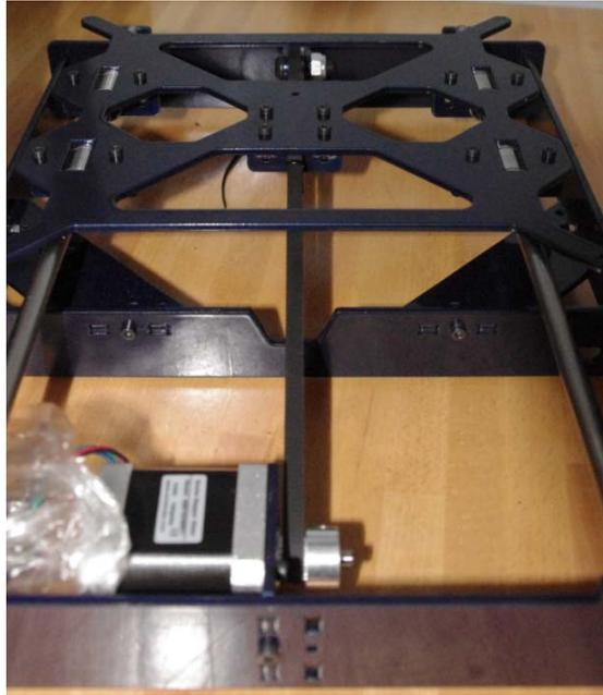
Ilustración 62. Instalación de correa eje Y.
