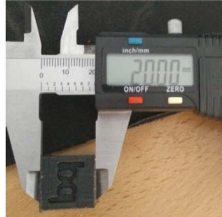
Ilustración 146. Resultado test cubo de calibración eje Y.
