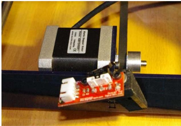
Ilustración 105. Montaje *endstop* eje Y.
