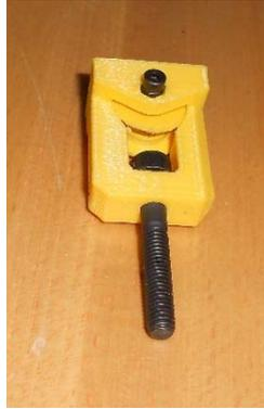
Ilustración 197. Tensor de correa de eje X.
