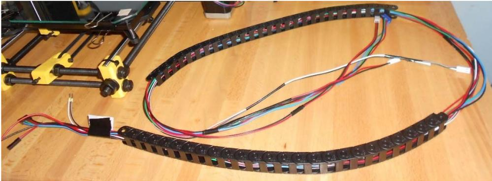
Ilustración 216. Introducción de cableado en la cadena portacables.
