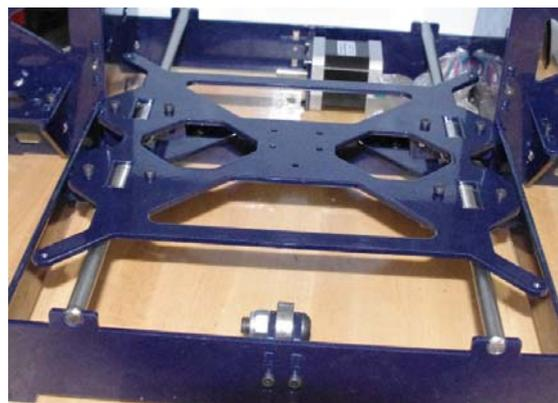
Ilustración 61. Instalación base de eje Y.
