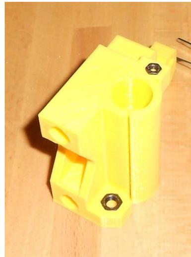
**Ilustración 195.** Montaje de tuercas en elemento de eje X.
