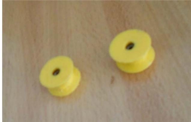
**Ilustración 193.** Poleas para movimiento de las correas de ejes X e Y.
