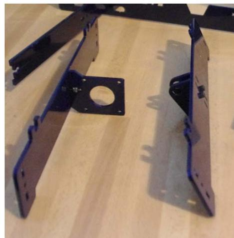
Ilustración 50. Montaje elementos de sujeción de correa de eje Y.
