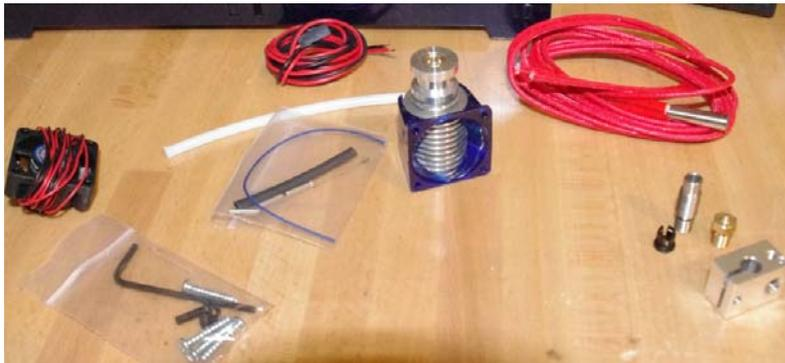
Ilustración 90. Elementos para el montaje del extrusor.
