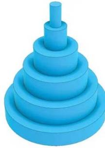
Ilustración 169. *Dimensional accuracy test*. Fuente: Revista Make vol.42
