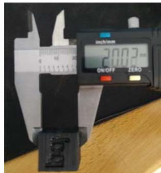
Ilustración 165. Medición eje Z cubo de calibración primer extrusor.
