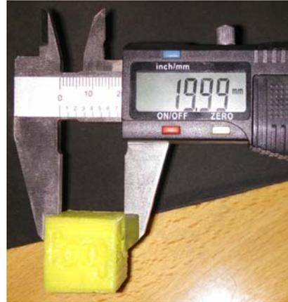
Ilustración 167. Medición eje Y cubo de calibración segundo extrusor.
