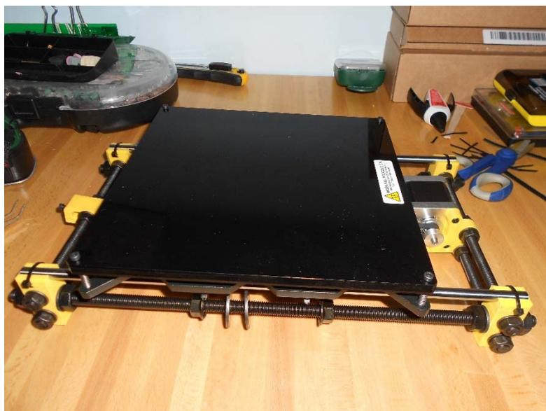
**Ilustración 207. Instalación de base de metacrilato.**
