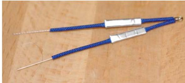
**Ilustración 92. Montaje termistor.**
