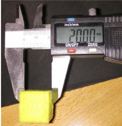
Ilustración 166. Medición eje X cubo de calibración segundo extrusor.
