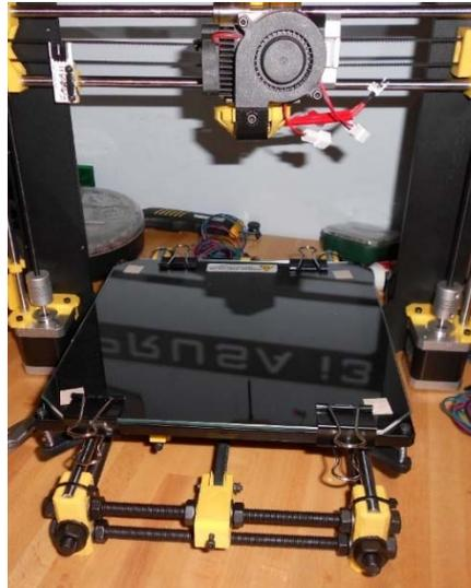
Ilustración 212. Colocación de vidrio.
