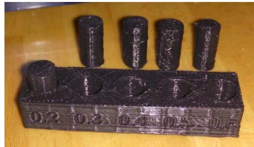
Ilustración 158. *Tolerance test*.
