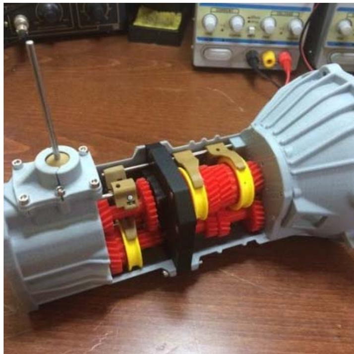
Ilustración 1. Caja de cambios de 5 velocidades para motor Toyota 22RE. Fuente: <http://3dprint.com/50265/3d-printed-toyota-transmission/>
