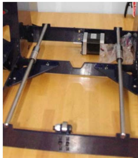
**Ilustración 58. Montaje motor y rodamiento de eje Y.**
