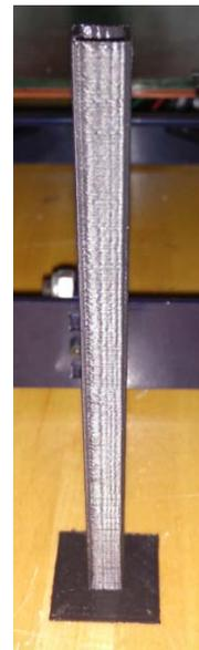
Ilustración 162. *Z resonance test*.
