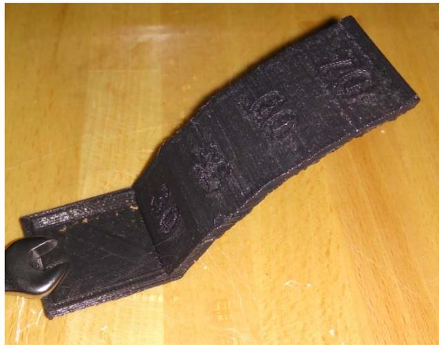
Ilustración 151. *Overhang test*.
