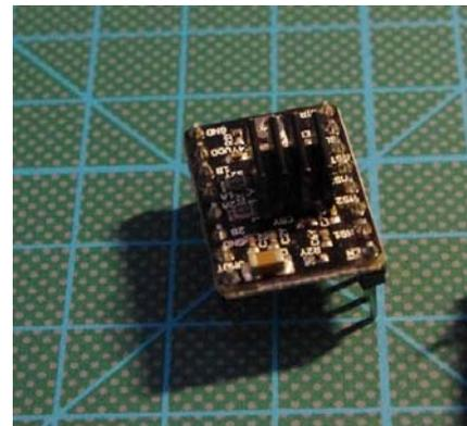
Ilustración 103. *Driver* para motor A4988.
