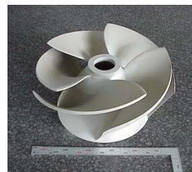
**Ilustración 12. Hélice realizada por la técnica SHS. FUENTE: <http://www.eis.uva.es/~macromol/curso13-14/impresoras3D/SHS.html>**
