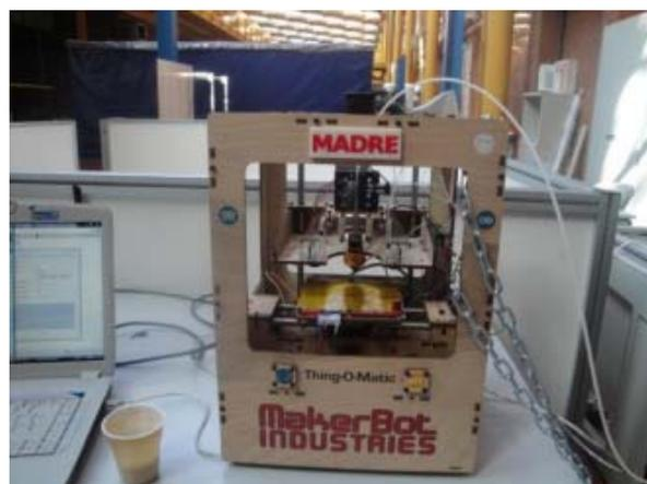
Ilustración 29. Madre, primera impresora de Clone Wars, modelo Thing-O-Matic de MakerBot. Fuente: [www.reprap.org/wiki/Proyecto\\_Clone\\_Wars](http://www.reprap.org/wiki/Proyecto_Clone_Wars)
