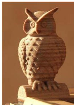
Ilustración 41. Pieza realizada a base de Laywoo-D3. Fuente: [www.formizable.com](http://www.formizable.com)
