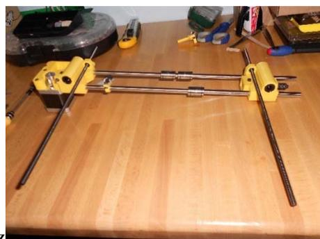
Ilustración 203. Montaje varillas roscadas.
