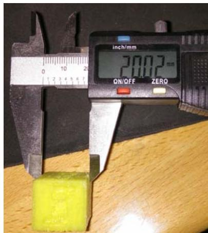
Ilustración 168. Medición eje Z cubo de calibración segundo extrusor
