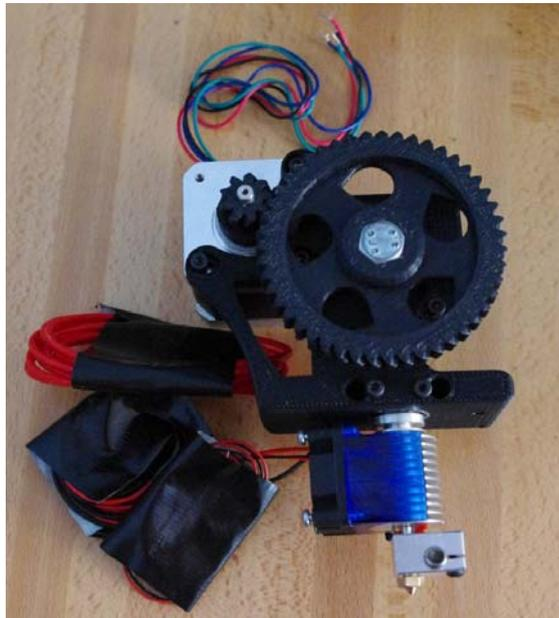
Ilustración 98. Bloque extrusor finalizado.
