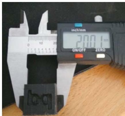
Ilustración 145. Resultado test cubo de calibración eje X.
