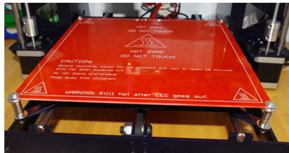
Ilustración 89. Montaje cama caliente sobre base del eje Y.
