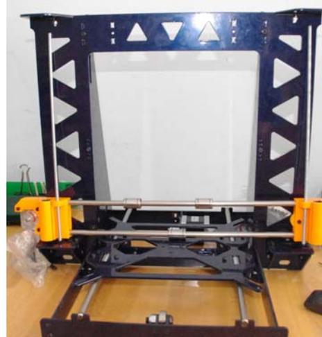
Ilustración 70. Acoplamiento del eje X a la estructura.
