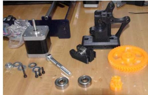
Ilustración 80. Piezas para el montaje del bloque del extrusor.
