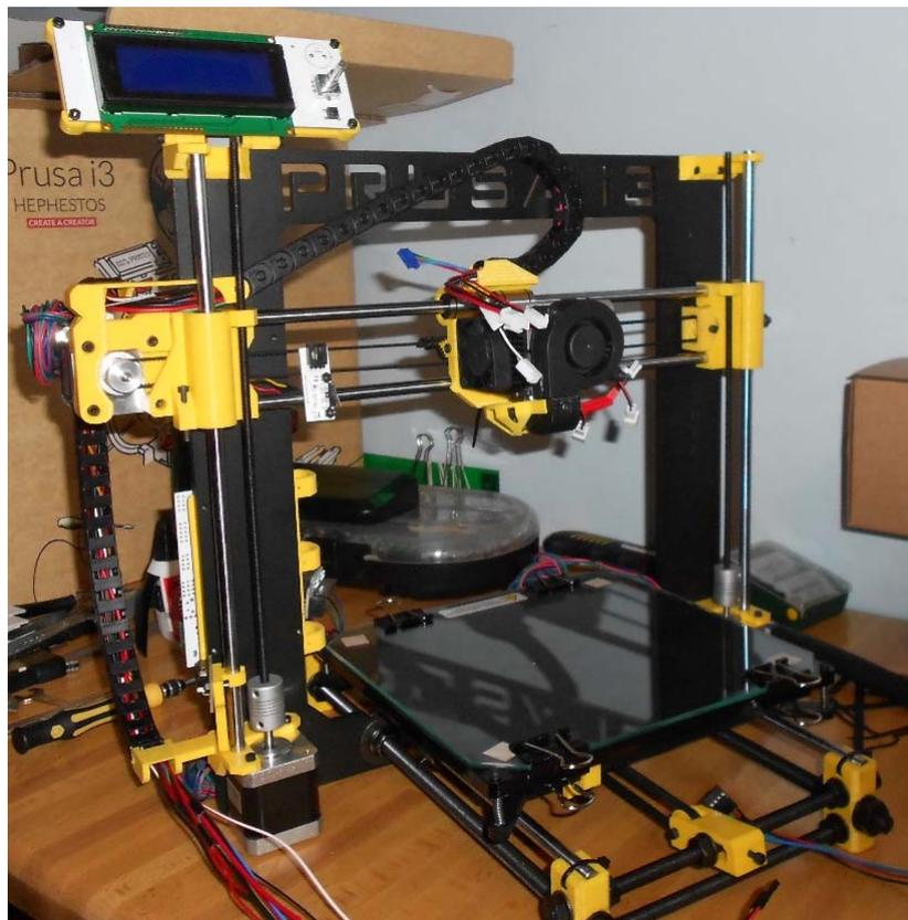
Ilustración 217. Instalación cadena portacables.
