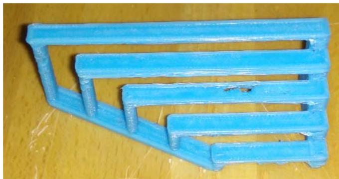
Ilustración 154. *Bridging test con ABS*.
