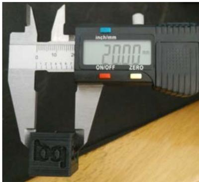
Ilustración 163. Medición eje X cubo de calibración primer extrusor.
