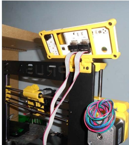
Ilustración 214. Instalación pantalla LCD.
