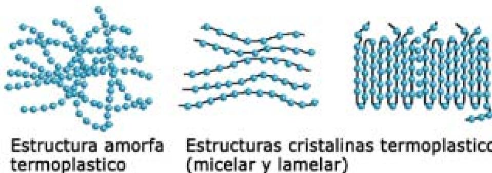
Ilustración 36. Estructuras de los termoplásticos. Fuente: <http://www.losadhesivos.com/termoplastico.html>
