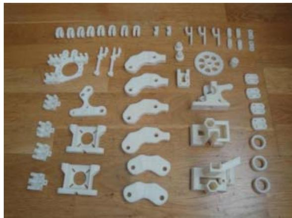
Ilustración 30. Primer juego de piezas para clonar una Prusa Mendel Iteración 2 hecho por un clon del Proyecto Clone Wars, por la Prusa Mendel R2. Fuente: [www.reprap.org/wiki/Proyecto\\_Clone\\_Wars](http://www.reprap.org/wiki/Proyecto_Clone_Wars)
