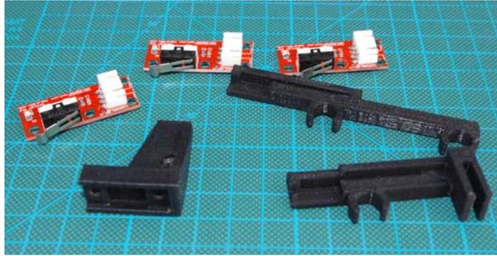
Ilustración 104. Finales de carrera y piezas imprimibles para su sujeción.
