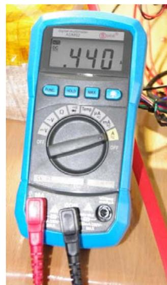
Ilustración 114. Consumo de la electrónica con el motor del eje X en funcionamiento.
