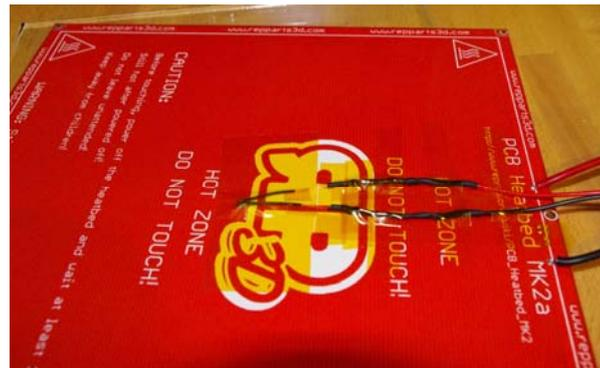
Ilustración 87. Asegurado de cableado de termistor de la cama caliente.
