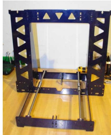
Ilustración 52. Formación de base de eje Y.
