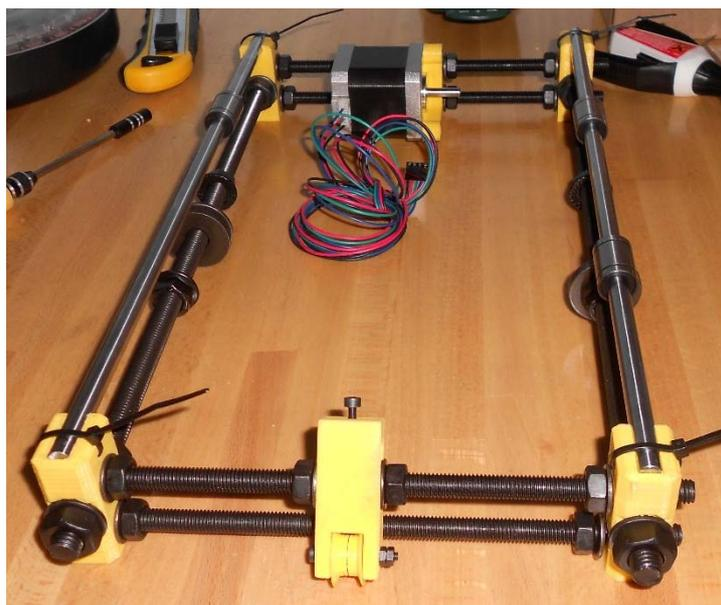
Ilustración 205. Montaje base de la impresora.
