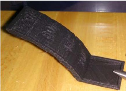
Ilustración 173. *Overhang test* extrusor 1.
