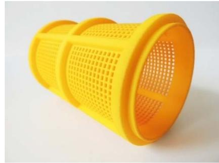
**Ilustración 10. Pieza realizada con sinterización selectiva por láser. FUENTE: [www.roechling-plastics.es](http://www.roechling-plastics.es)**
