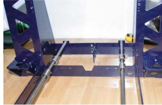
**Ilustración 56. Anclaje soportes de motores de eje Z a la estructura.**
