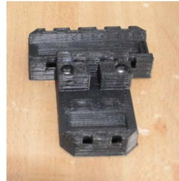
Ilustración 74. Colocación de tuercas en el *X-carriage*.
