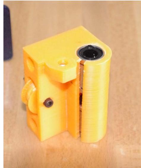
Ilustración 66. Montaje *X-Axis idler end*.
