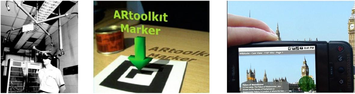
Figura 1.4: De izquierda a derecha, primer sistema de Realidad Aumentada de Sutherland, aplicación funcionando con la biblioteca ARToolKit, y Wikitude ejecutándose en un dispositivo móvil.
