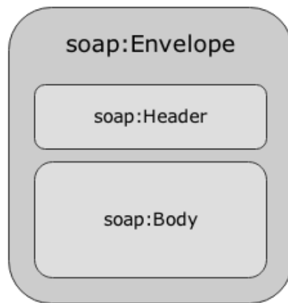
Figura 4.6: Estructura de un mensaje SOAP.
